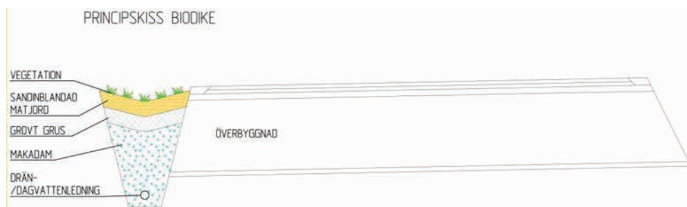
Figuren visar principsektion av biodike i anslutning till lokalgata.
