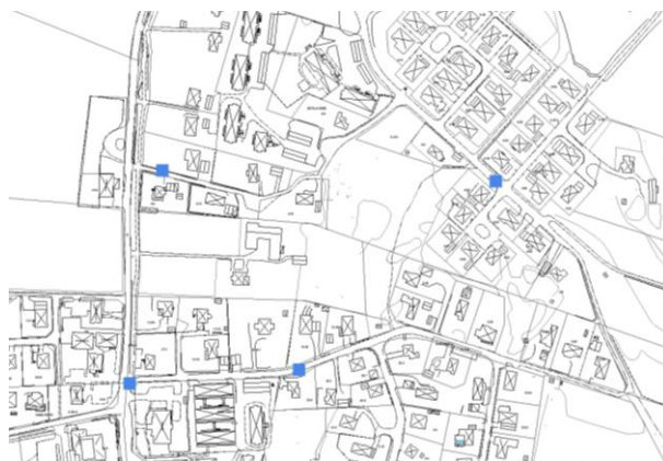
Figur 11: Befintliga brandposter runt planområdet.
