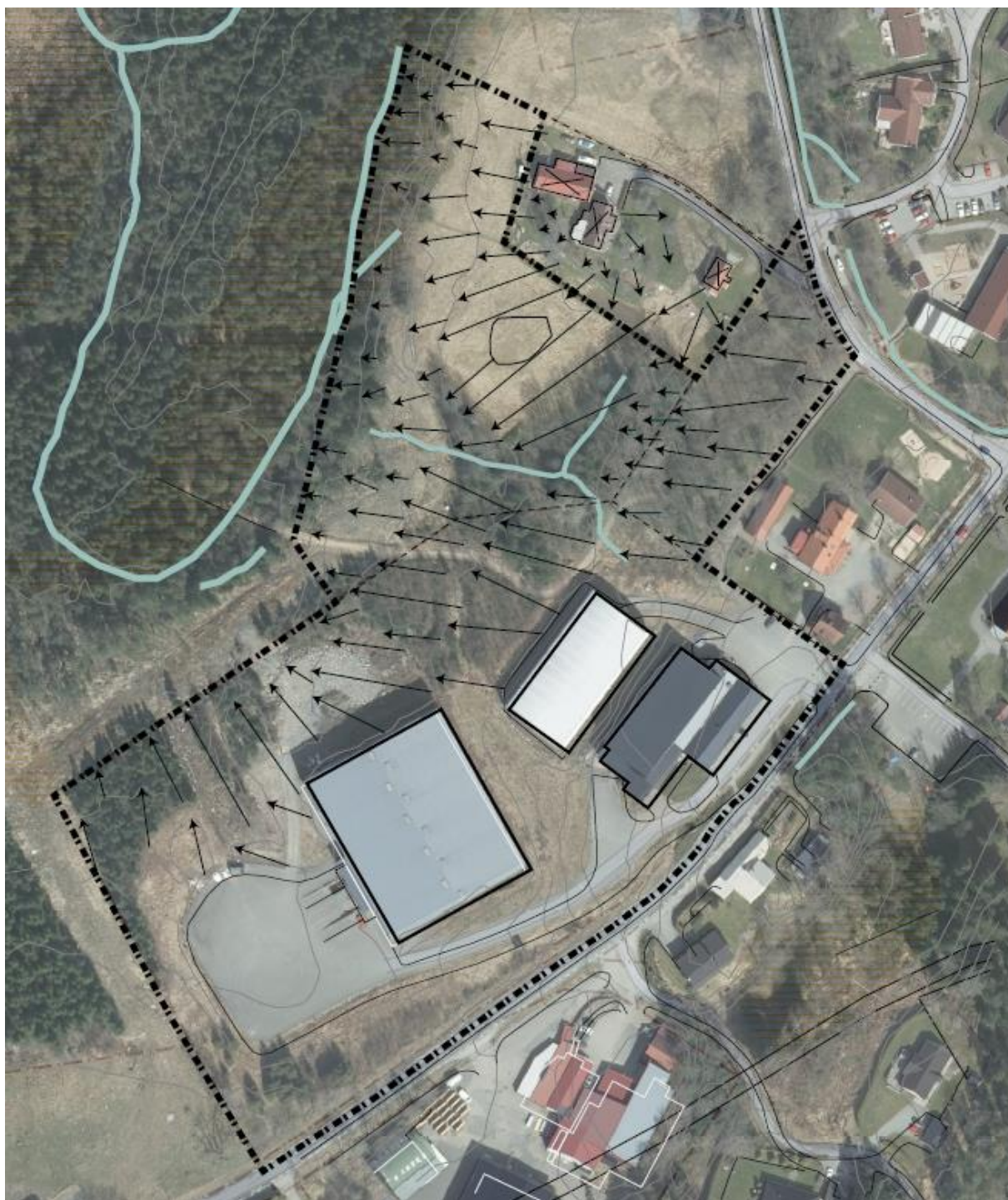
Kartläggning över yttlig vattenavrinning. Topologin sluttar naturligt mot skog och våtmark, där en utbyggnad enligt planförslaget inte bör påverka den yttliga avrinningen eller skapa instängda områden/lågpunkter.
