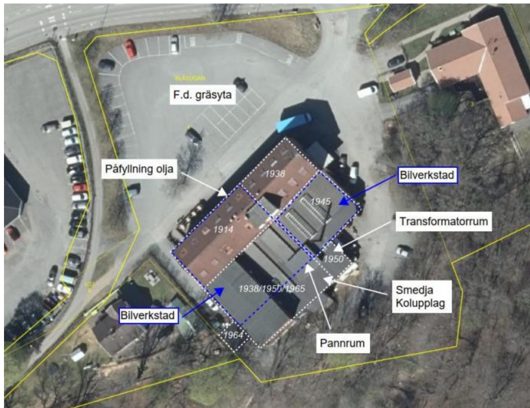
Figur 7- Bedriven verksamhetsutveckling utifrån bygglovshandlingar och platsbesök (Miljöteknisk utredning Enrecon).
