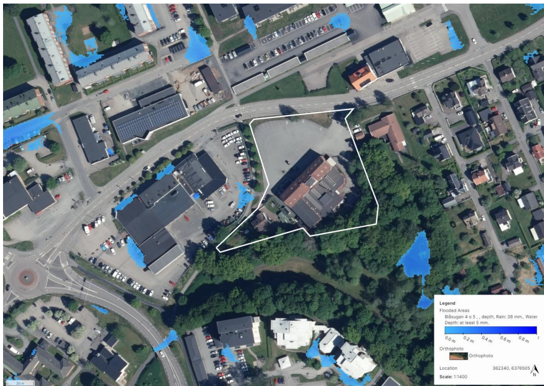
Figur 30- Skyfallsanalys för ett 100 års regn. Blåa områden visar på områden som översvämmas vid skyfall (SCALGO Live, 2024).
