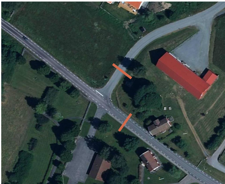
Figur 1-1 Utplacerade slangar för mätning av trafik vid fyrvägs-korsningen Helsjövägen-Loftgårdsvägen. Källa: Eniro karttjänst (med tillagda markeringar, Trivector).
