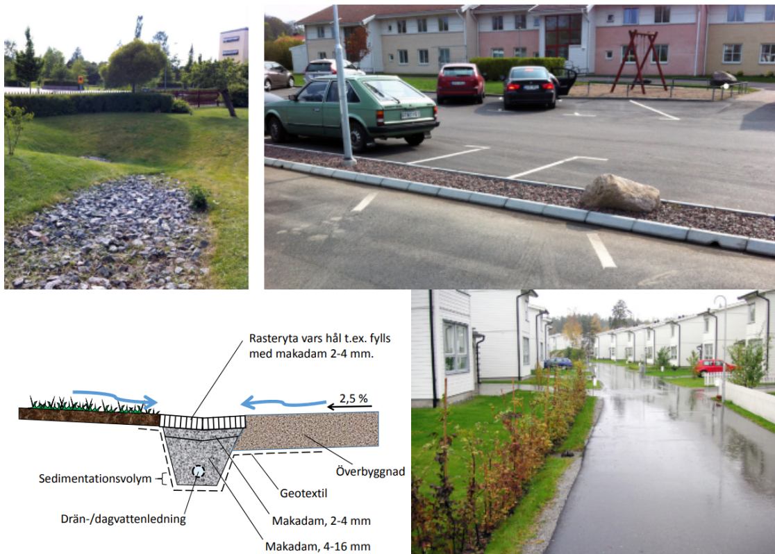
Figur 23- Exempel på makadamdiken (Stockholmvattenochavfall).
