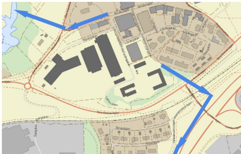
Principbild avledning av dagvatten
