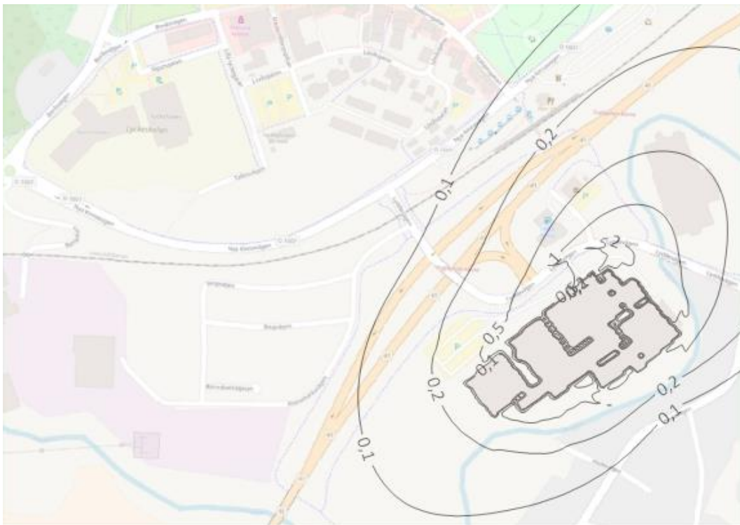
Figur 7 Spridningsberäkningar av utsläppen av ammoniak från Almedahls som årsmedelvärde för ett scenario där utsläppen motsvarar dagens nivåer. Haltbidraget är beräknat i enheten ( \mu\text{g}/\text{m}^3 ).
