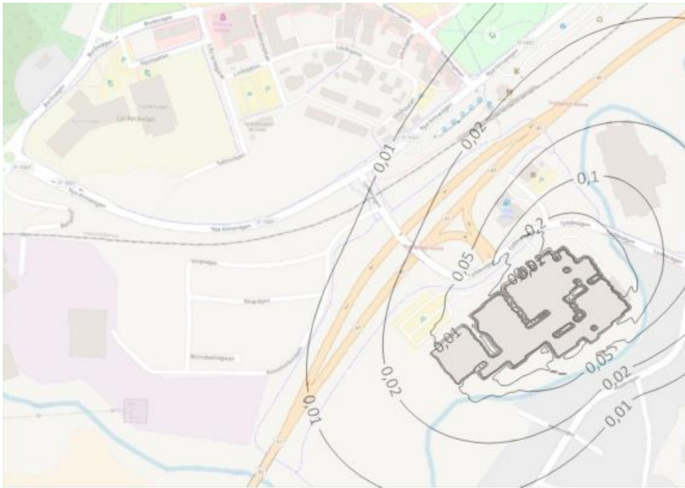
Figur 6 Spridningsberäkningar av utsläppen av formaldehyd från Almedahls som årsmedelvärde för ett scenario där utsläppen motsvarar nivåer som tillåts enligt BAT-slutsatserna för textilindustrin. Haltbidraget är beräknat i enheten ( \mu\text{g}/\text{m}^3 ).
