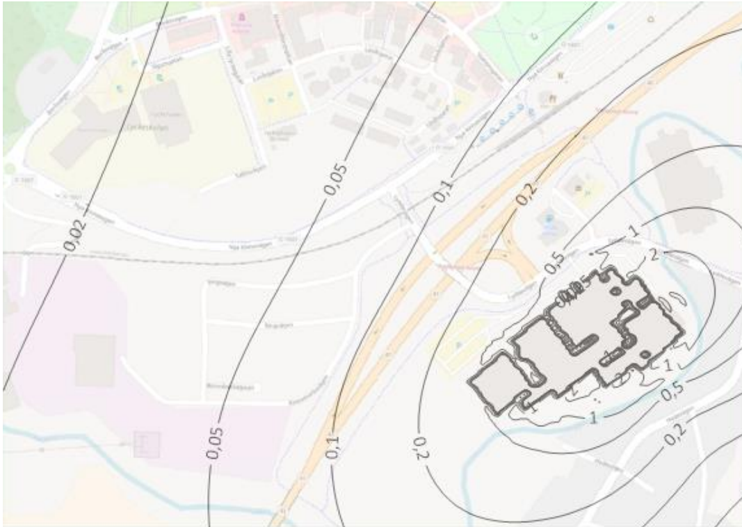
Figur 11 Spridningsberäkningar av utsläppen av oljeaerosol från Almedahls som årsmedelvärde för nuläges scenariot. Haltbidraget är beräknat i enheten ( \mu\text{g}/\text{m}^3 ).
