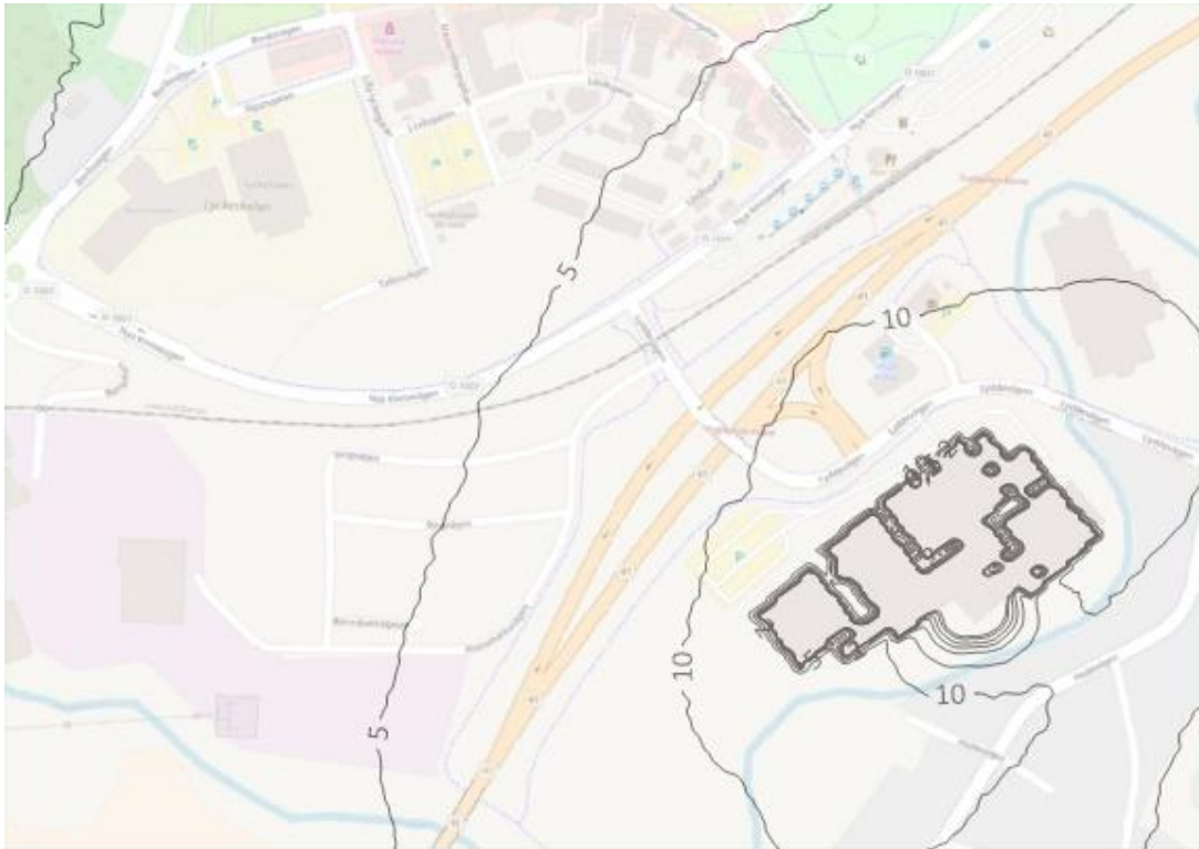
Figur 17 Spridningsberäkningar av haltbidraget av NO 2 från Almedahls som 98e percentilen av timmedelvärdena för ett nuläggesscenario. Haltbidraget är beräknat i enheten (µg/m 3 ).
