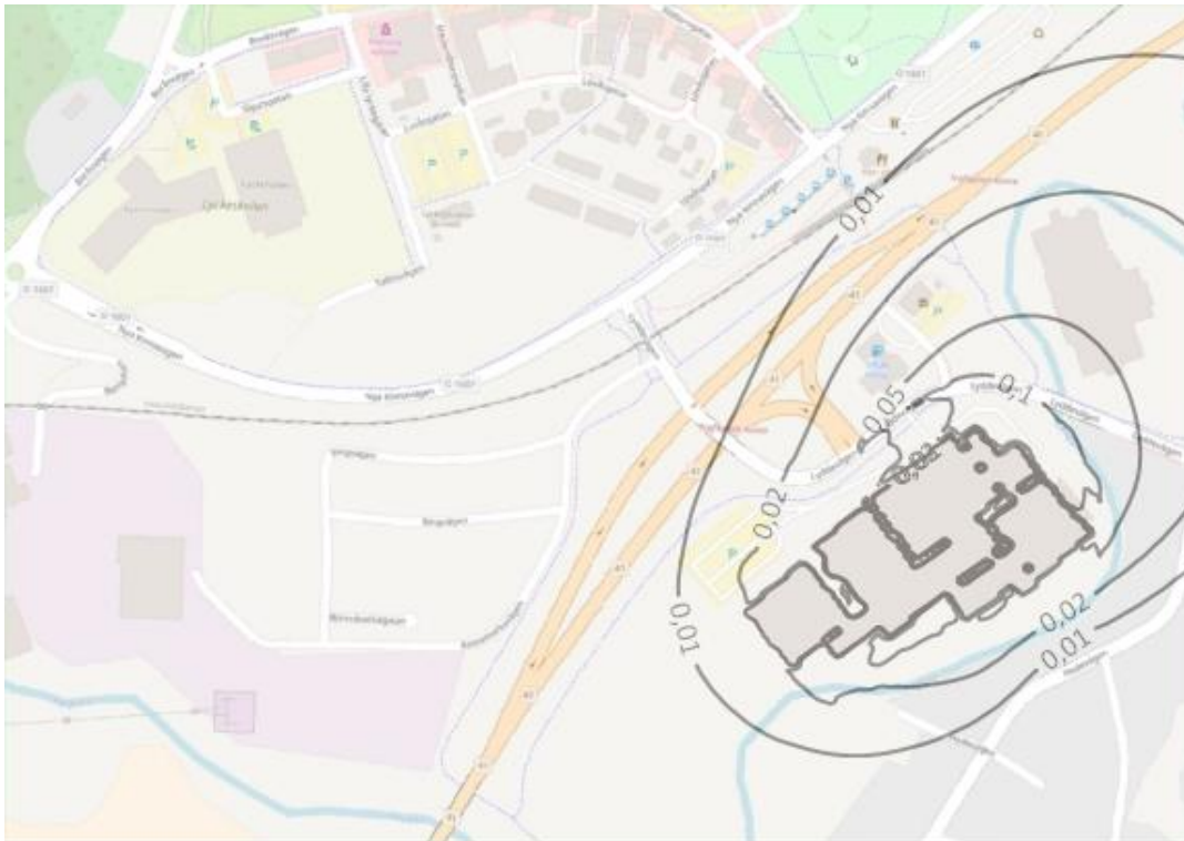
Figur 5 Spridningsberäkningar av utsläppen av formaldehyd från Almedahls som årsmedelvärde för ett scenario där utsläppen motsvarar dagens nivåer. Haltbidraget är beräknat i enheten ( \mu\text{g}/\text{m}^3 ).
