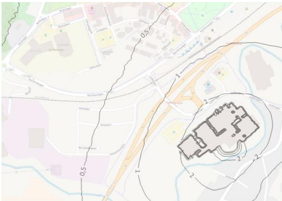
Figur 19 Spridningsberäkningar av haltbidraget av SO 2 från Almedahls som 98e percentilen av timmedelvärdena för ett nuläggesscenario. Haltbidraget är beräknat i enheten (µg/m 3 ).
