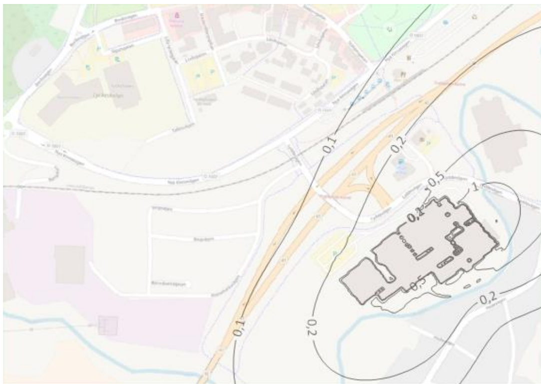
Figur 13 Spridningsberäkningar av utsläppen av stoft från Almedahls som årsmedelvärde för ett nuläggesscenario. Haltbidraget är beräknat i enheten ( \mu\text{g}/\text{m}^3 ).
