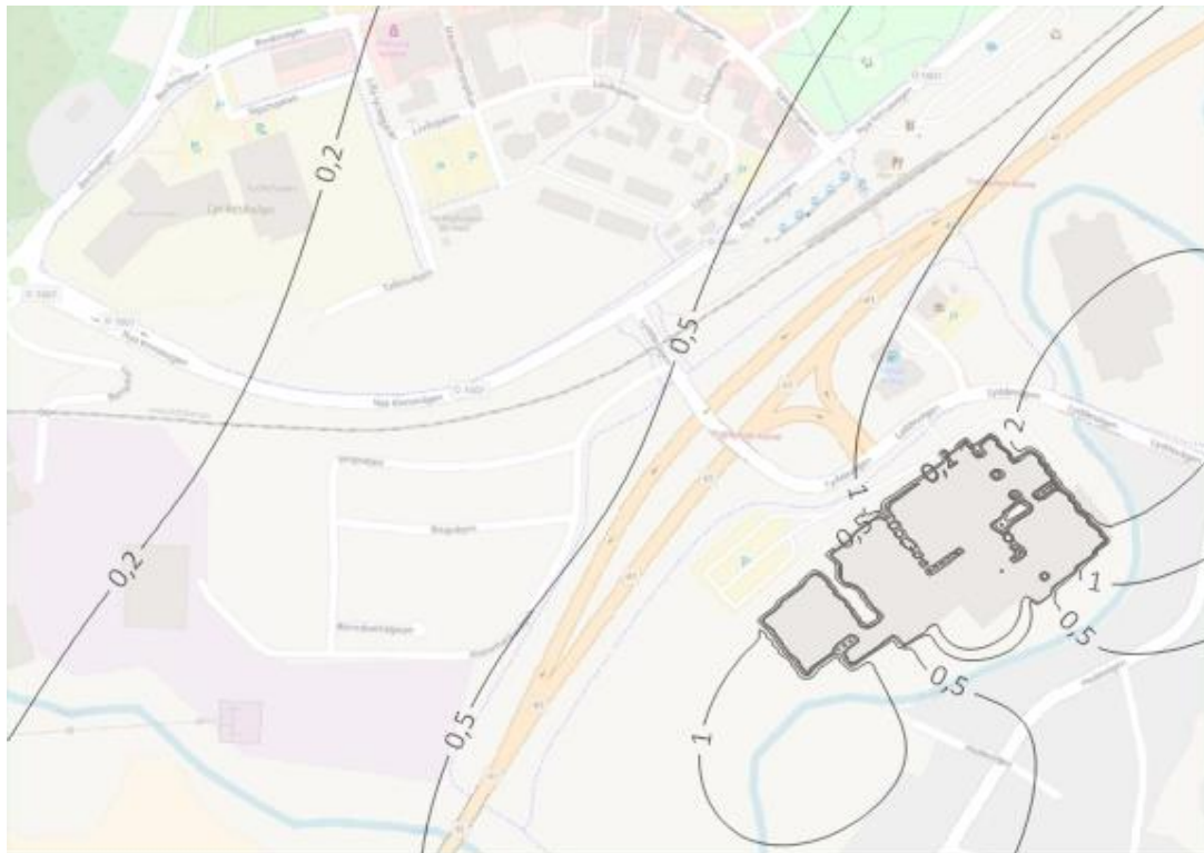
Figur 15 Spridningsberäkningar av haltbidraget av \text{NO}_2 från Almedahls som årsmedelvärde för ett nuläggesscenario. Haltbidraget är beräknat i enheten ( \mu\text{g}/\text{m}^3 ).
