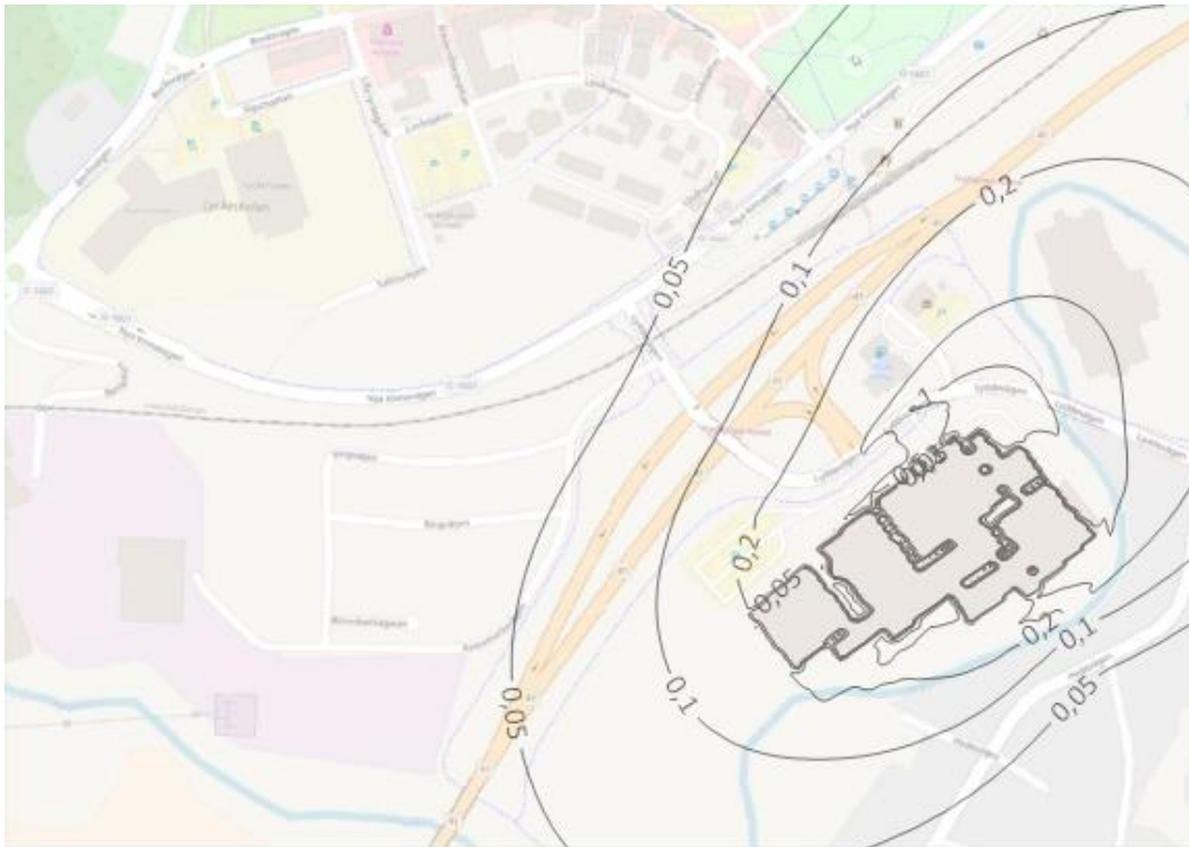
Figur 8 Spridningsberäkningar av utsläppen av ammoniak från Almedahls som årsmedelvärde för ett scenario där utsläppen motsvarar den nivå som tillåts enligt BAT-AEL. Haltbidraget är beräknat i enheten ( \mu\text{g}/\text{m}^3 ).
