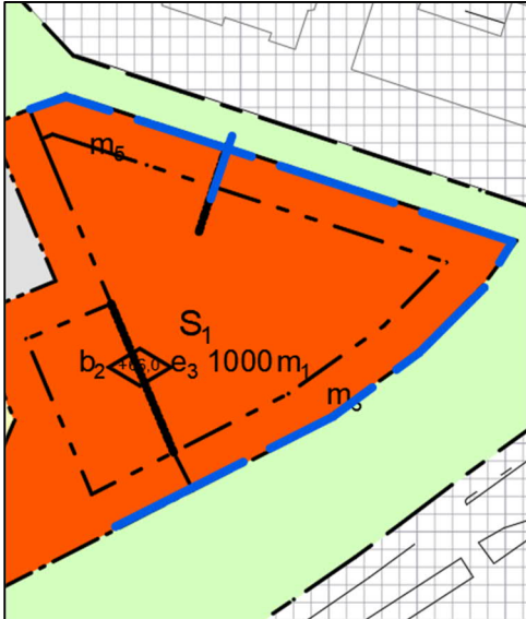
Figur 5. Placering av bullerskyddsskärmar (blå linje) där m_5 är 2 m ö mark, m_6 är 3 m ö mark. Källa: Marks kommun.
