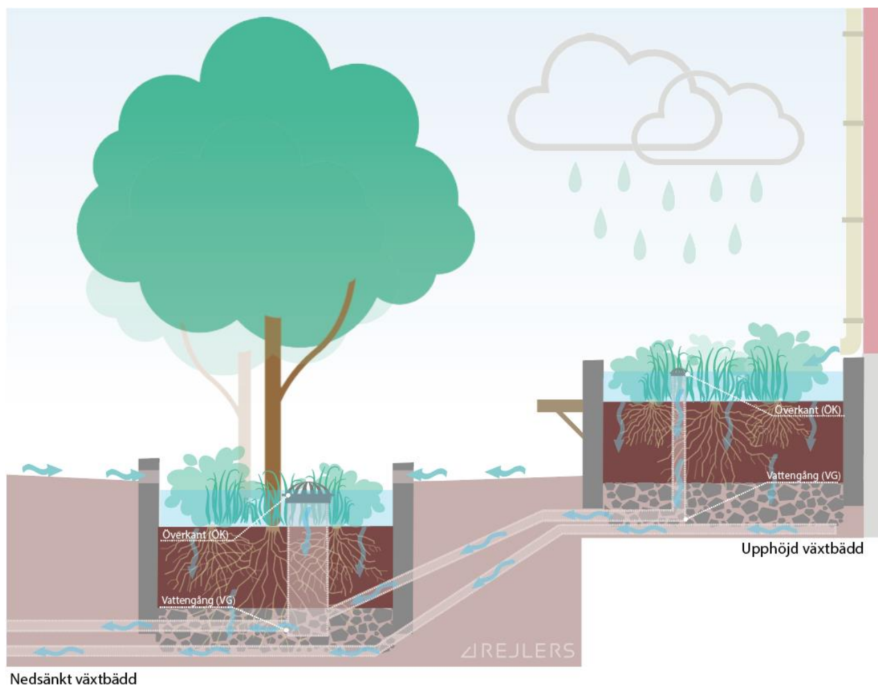
Figur 15: Nedsänkt- och upphöjd Regnbädd/Biofilteranläggning.
