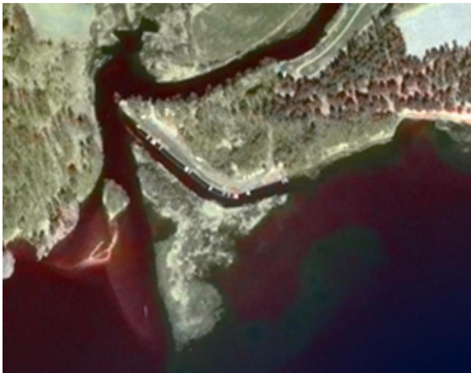
Figur 2. Flygfoto över Storåns mynning i Lygnern 2009. Den utgrävda kanalen med småbåtshamnen går österut mot Sätilla sand. Ön utanför kanalen har bildats successivt av deponerade sediment från Storån. En liten ö i huvudfåran håller nu på att bildas. Källa: Marks kommun
