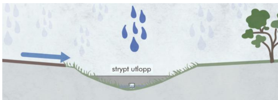
Figur 9. Principskiss svackdike (källa: Sweco)
