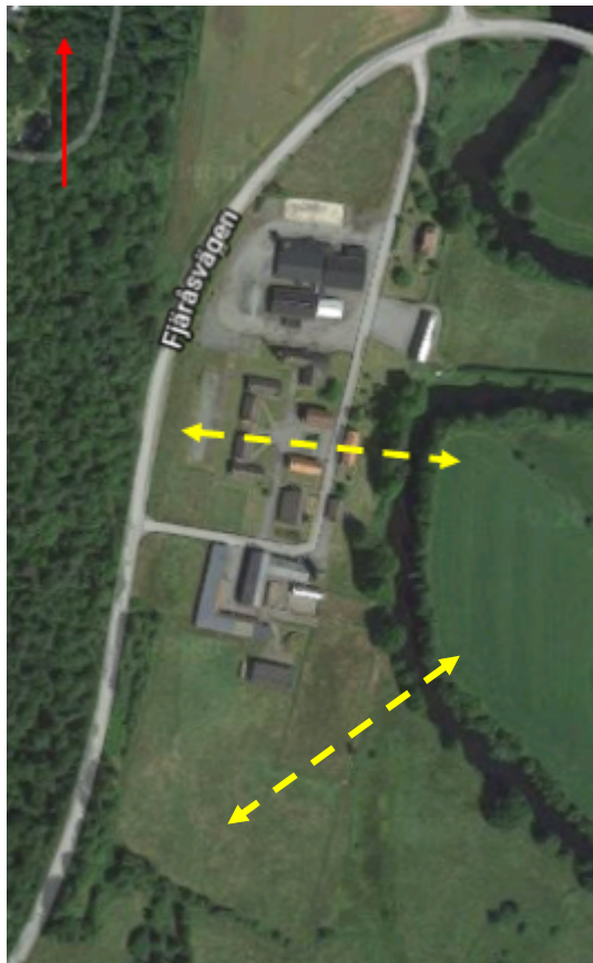
Figur 6-1 Beräkningssektioner för kontroll av stabilitet
