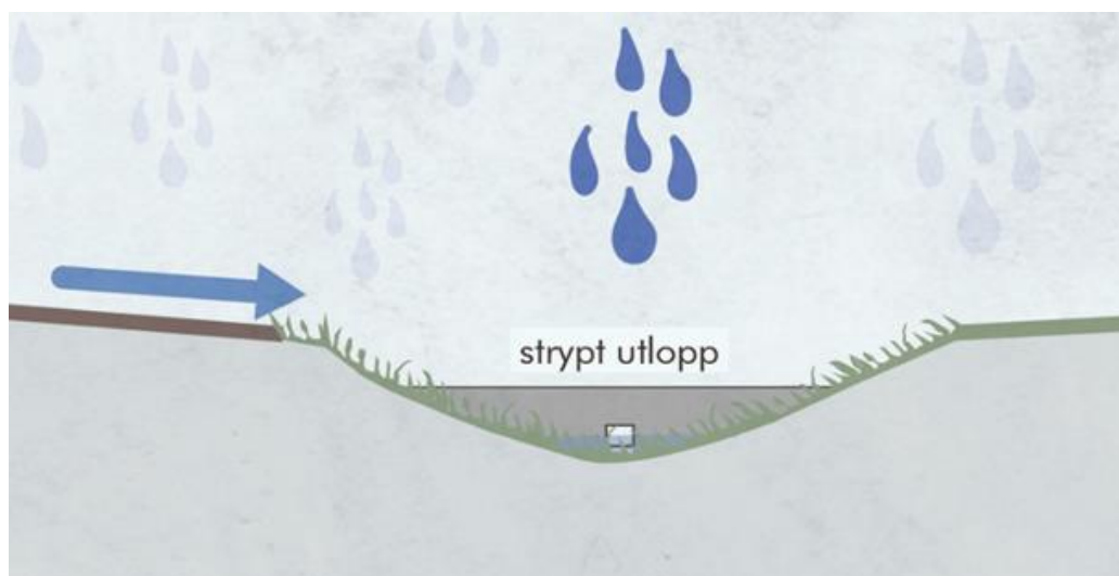
Figur 13. Principskiss för svackdike. Framtagen av Sweco.
