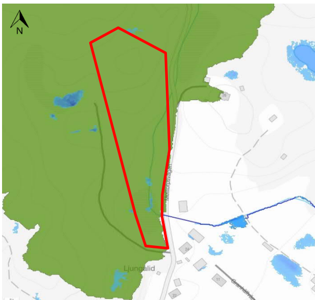
Figur 9. Grönt område markerar avrinningsområde till den södra trumman under Melltorpsvägen (trumma B). Hela planområdet (markerat i rött) avrinner till trumman.
