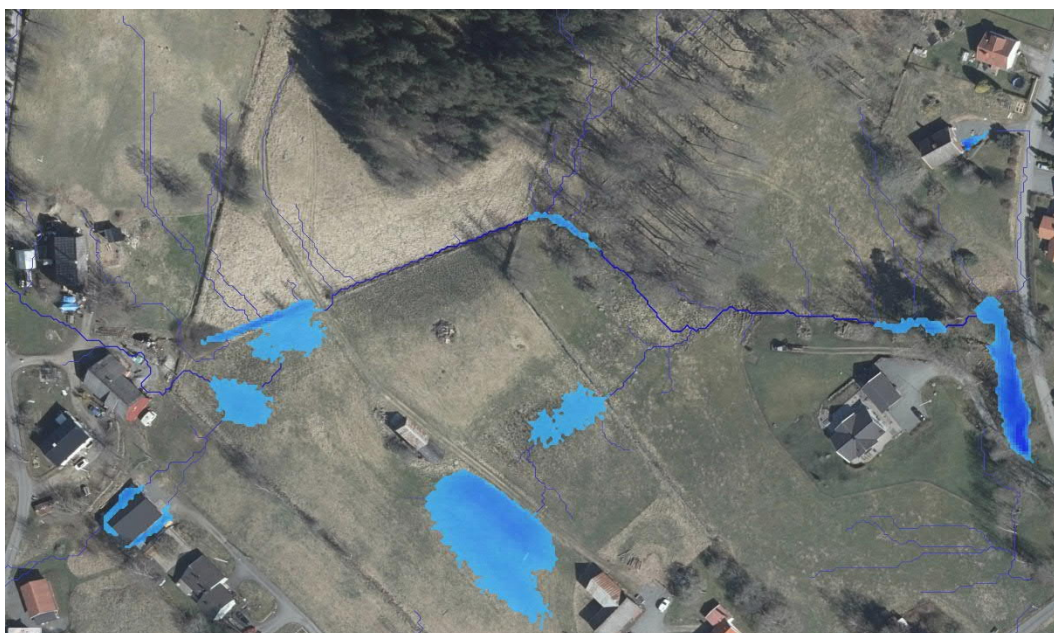
Figur 26. Översvämningsytor nedströms planområdet och fastigheten MARK MELLTORP 1:18. Konsekvensen av att öka flödet till diket har simulerats genom att plocka bort befintliga trummor. Bedömningen är att inga byggnader hotas. Bildkälla: SCALGO Live.
