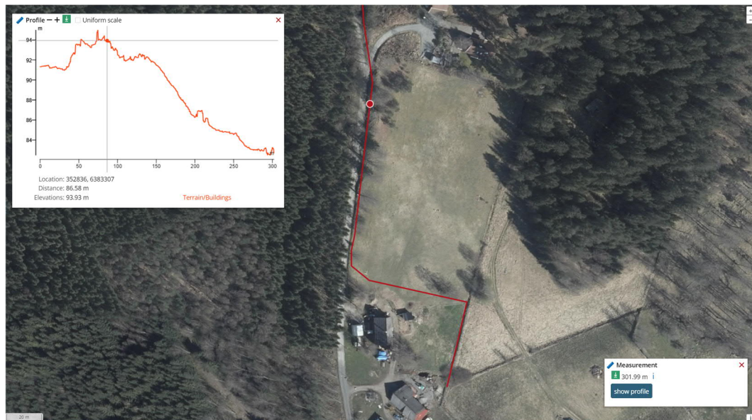
Figur 27. Översiktligt förslag till omledning av diket som avleder naturmarken uppströms planområdet. Om avrinningen inte leds in i planområdet minskar risken för översvämning, även för den befintliga bebyggelsen på fastigheten MARK MELLTORP 1:18. Bildkälla: SCALGO Live.
