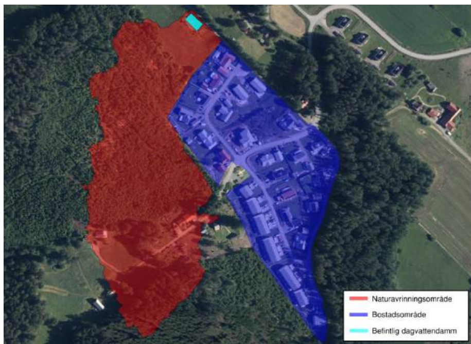
Figur 16 - Uppskattning av avrinningsområde till befintlig dagvattendamm
