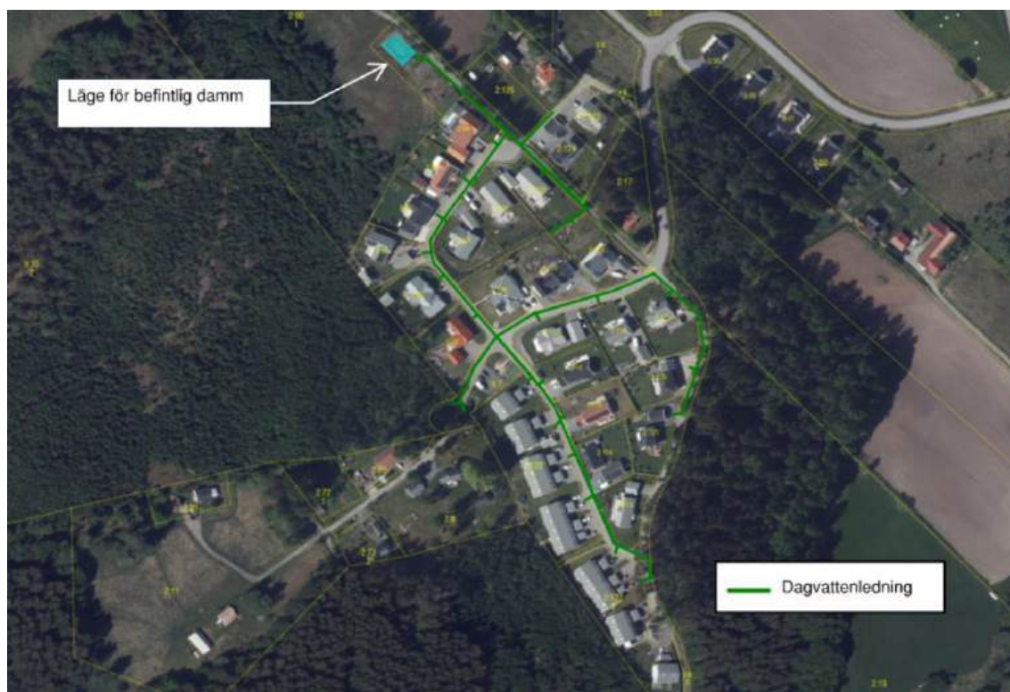
Figur B5.1 - Beskrivning av läge för befintligt dagvattennät i närliggande bostadsområde
