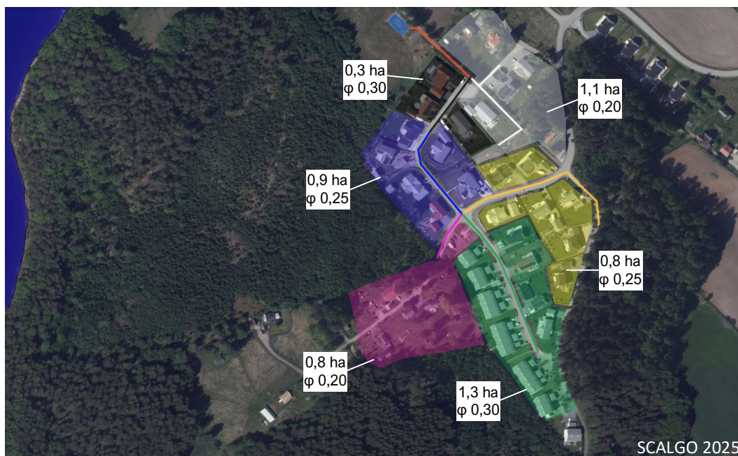
Figur 2 Befintligt dagvattennät och dess omgivande bebyggda ytor
