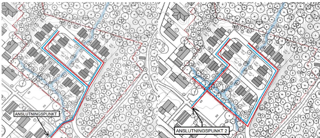
Figur 19 – ledningsdragningar för spillvatten
