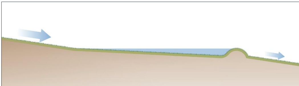
Figur 11. Schematisk bild på fördröjning i dike med hjälp av dämning.
