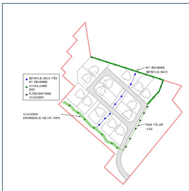
Figur 15. Principskiss för dagvattenhantering på allmän platsmark med svackdike.
