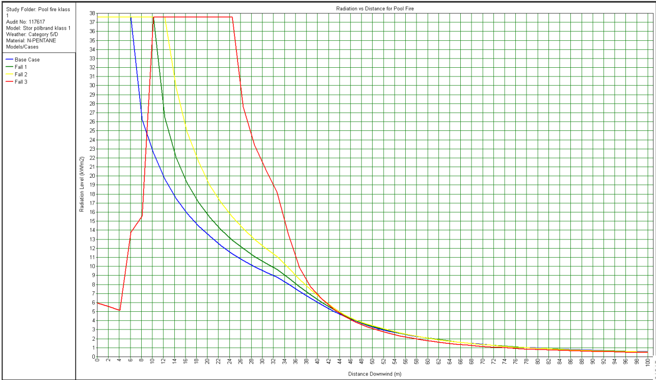
Figur C-5. Strålningsnivå i kW/m² på olika höjd över mark som funktion av avstånd. Brandscenario; pölbrand 200 m², bensin, vind 5 m/s. De olika fallen beskriver strålningen på olika höjd över marken (Base Case= 0 m, Fall 1=2 m, Fall 2=5 m och Fall 3=15 m). Not: Avstånd (x-axel) räknas från centrum av pöl.
