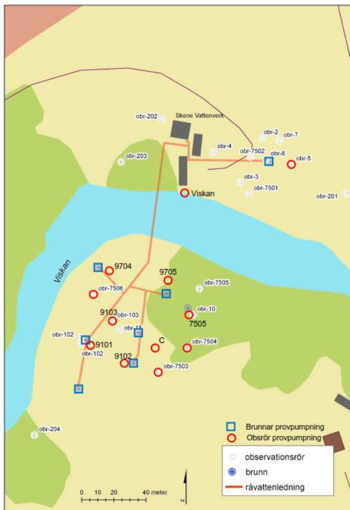
Figur 4. Lokalisering av brunnar och observationsrör vid Skene vattenverk, se vattenverkets läge i Figur 3. (Källa: Marks kommun. Sweco rapport "Skene Provpumpning" 2018-04-20).
