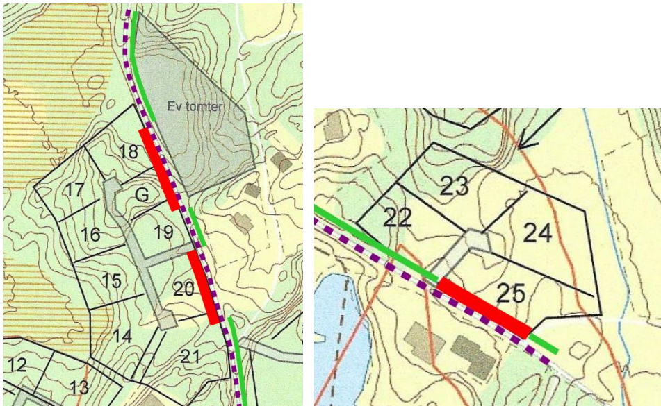
Figur 8 Siktanalys (gäller båda sidor om Jägmästarevägen). Röd: Siktproblem för anslutningar. Grön: Lämplig sträcka för anslutning. Lila: Analyserad sträcka
