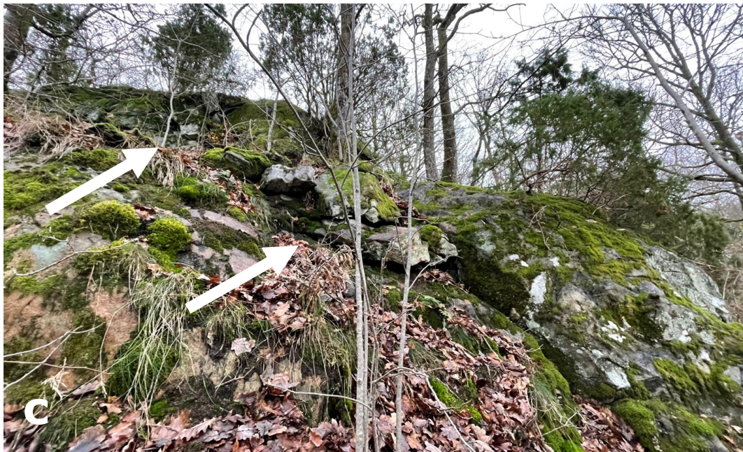
Figur 1-4. Område 1. Vy mot N. Slänt mot Kalvviksvägen. Läge för potentiellt instabila block redovisas.
