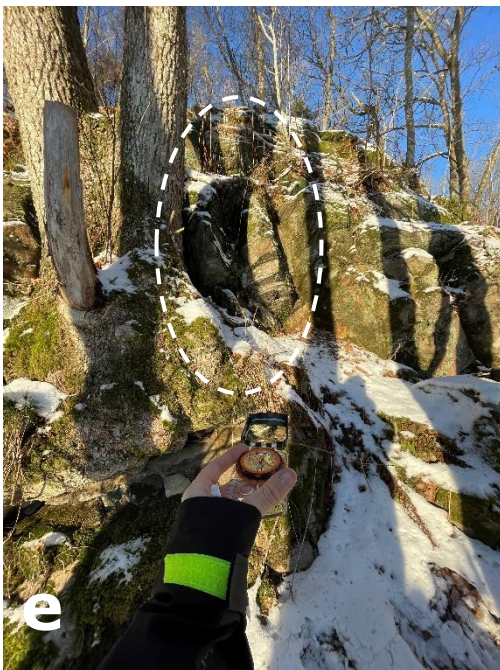
Figur 1-8. Område 2. T.v. Exempel på block som bedöms vara stabilt för befintliga förhållanden men som kan bli instabilt till följd av vibrationer från markarbeten. T.h. Detaljbild.
