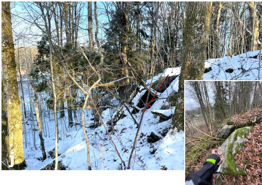
Figur 1-16. Område 3. Vy mot N. Brantstående strukturer med strykning/stupning 230/50, se röd, streckad linje. Slänten bedöms stabil för befintliga förhållanden. Infälld figur, detaljbild.
