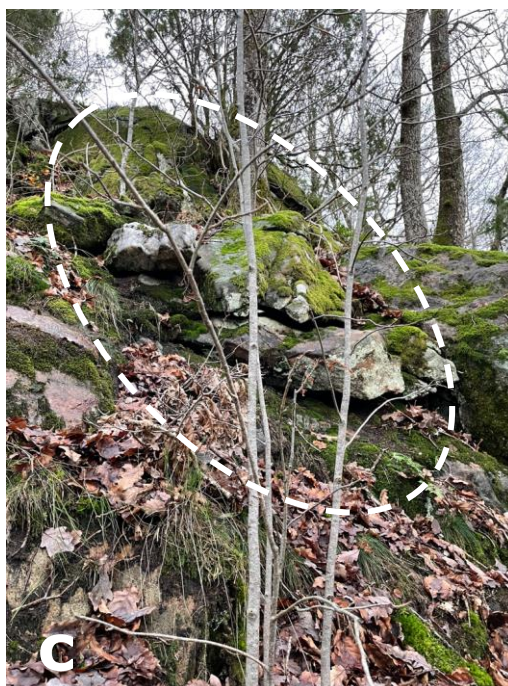
Figur 1-6. Område 1. T.v. Detaljbild potentiellt instabila block. Block strax under släntrönn. Block vilar på subhorisontella ytor och bedöms i nuläget stabila, vegetation i bakkant kan medföra framtida instabilitet. Vegetationsrensning och rensning av lösa block rekommenderas. T.h. Detaljbild potentiellt instabila block. Lösa block på sluttande yta ut mot Kalvviksvägen, rensning av lösa block rekommenderas.
