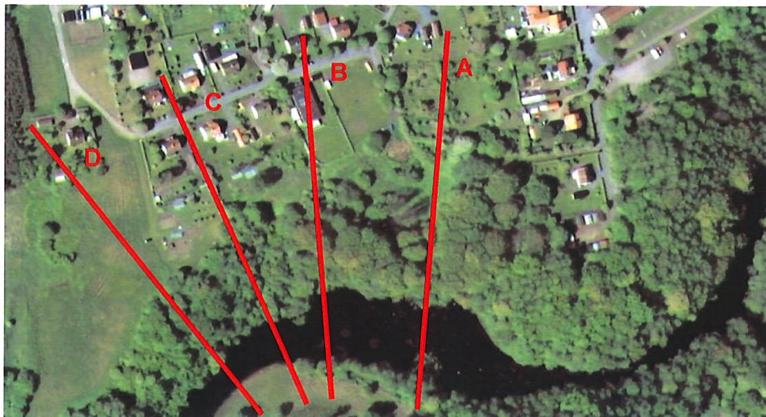
Figur 7 Lägen för beräkningssektioner i vilka stabiliteten har analyserats.
