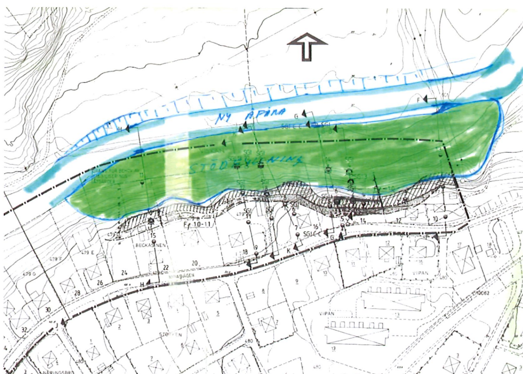
Figur 2 Omgrävning av Viskan samt stödfyllning (utförd 1994) öster om fastigheten Mark Kinna 24:155. (Göteborgs Förorter, 1991-03-10, arbetsnr. 34306 049 230, kommun ID 97, 97B)
