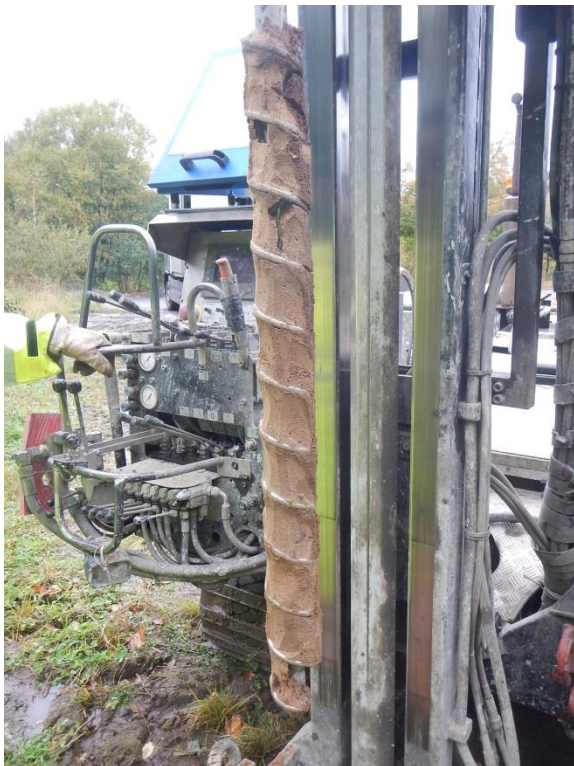
Figur 5. Prov togs ut med en bandgående borrvagn. Bilden visar en skruv från bormpunkten R1608.
