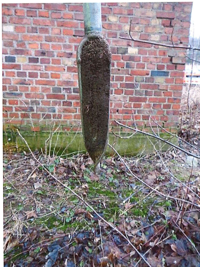
Figur 5. Prov togs ut med en handprovtagare. Bilden visar en skruv från borrhypunkten R1703.
