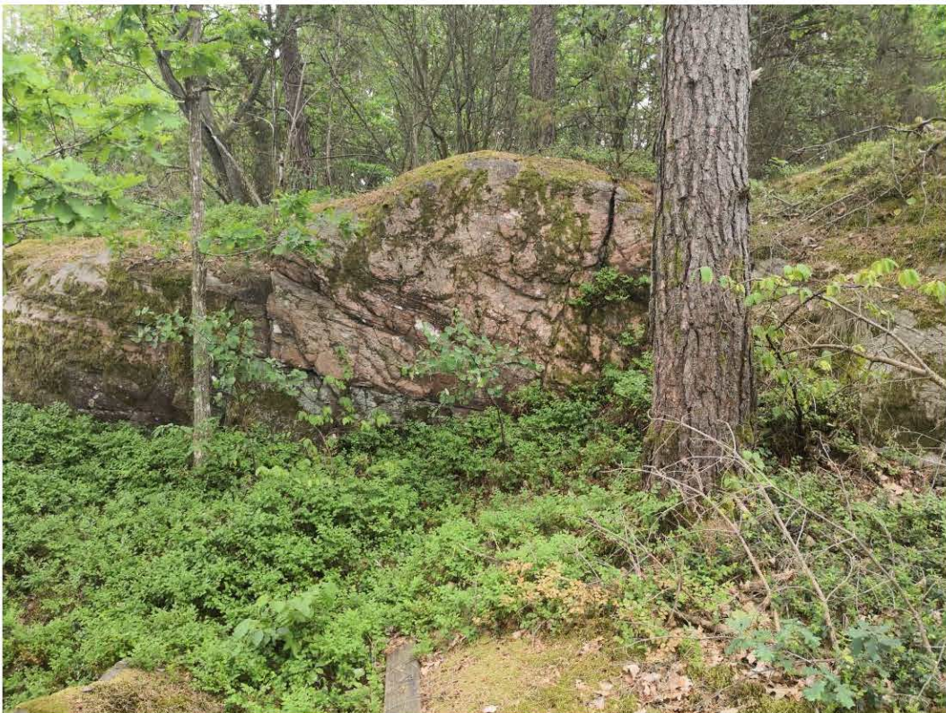
Figur 6: Plats 3, Finkornig röd gnejs. God yt- och storstabilitet. Ca 2,5 meter hög.
