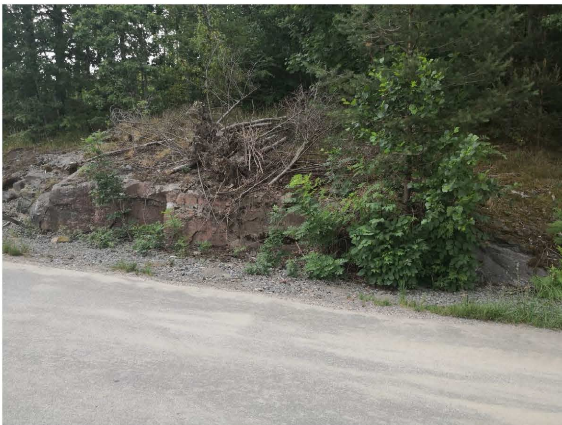
Figur 2: Plats 1, Finkornig röd och grå gnejs. Förekomst av pegmatit. God yt- och storstabilitet. 1-1,5 meter hög
