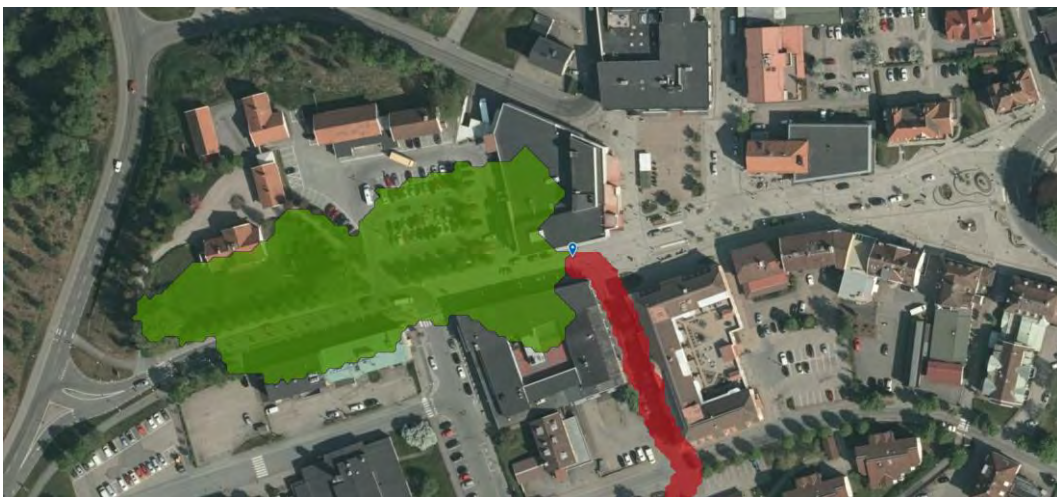
Figur 4. Avvattningsväg inom och runt södra delen av planområdet. Observera att detta inte tar ledningsnät och rännstensbrunnar i beaktning. Grön zon är avrinningsområde och röd zon är avrinningsväg.
