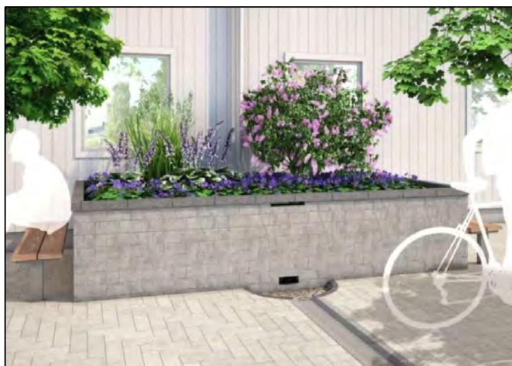
Figur 13. Takvatten som avvattnas till ett upphöjt biofilter via stuprör. Utlopp längst ned under jordlagren och vid toppen av den övre magasineringszonen. (Kent Fridell & Kristian Klasson, Tengbomgruppen AB, 2014).
