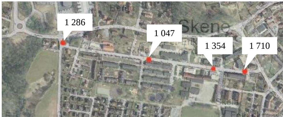
Figur 2-1 Trafikmätningar (motorfordon) längs Gästgivaregatan och Sjuhäradsgatan.
