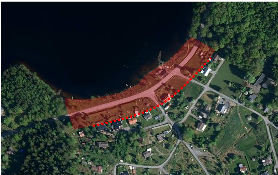
Figur 8-1. Önskas ytan mellan strandlinje och 25 m syd om Lindomevägen tillföras permanenta laster alt ändras med avseende på marknivåer bör detta föregås av stabilitetsutredning för specifikt objekt. Attefallshus är ok söder om vägen.
