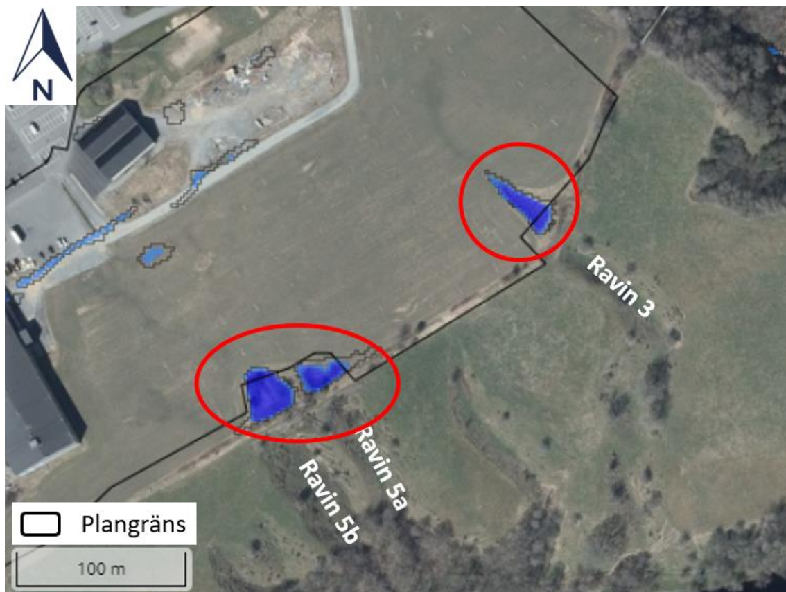
Figur 23 De röda cirkarna visar lågpunkterna uppströms spillvattenledningen som risker att vattenfyllas vid extrema regn.
