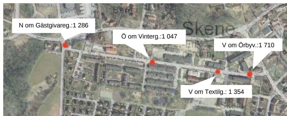
Figur 1 Trafikmätningar (motorfordon, ÅVDT) längs Gästgivaregatan och Sjuhäradsgatan.
