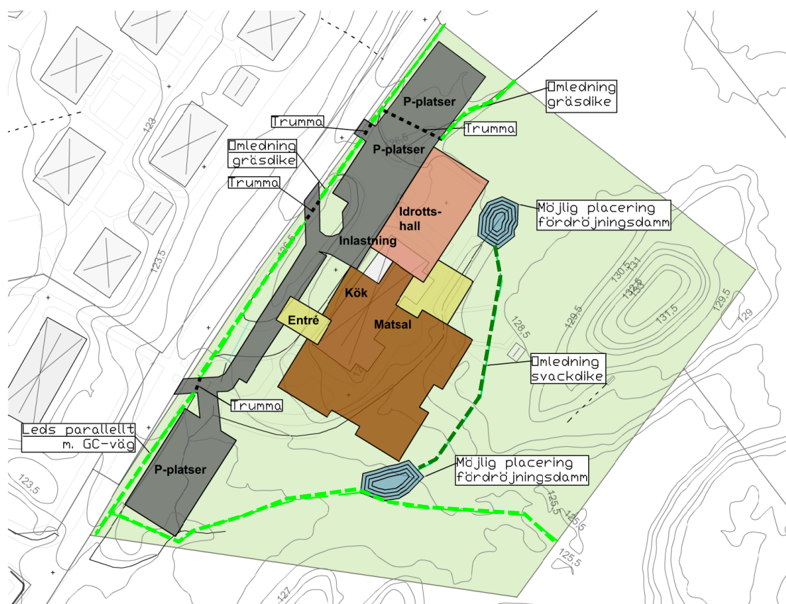
Figur 18. Lokalisering av föreslagen framtida dagvattenhantering. Ljusgröna linjer visar gräsdiken, mörkgrön linje svackdike, svarta streckade linjer trummor och blå ytor föreslagen placering av fördröjningsdamm.
