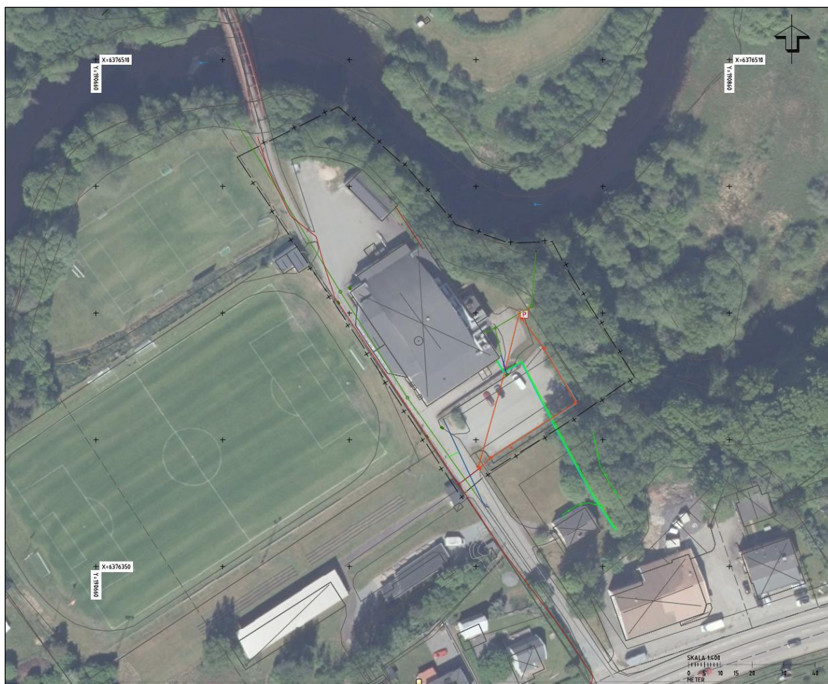
Figur 4: Visar interna och externa ledningar samt undersökningsområdet (Ledningskollen, 2025).
