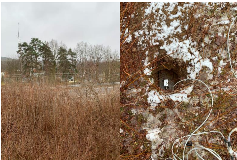
Figur 7 Foto till vänster visar läget för den vertikal givare CV nära nya kinnavägen. Foto till höger visar givaren monterad på trädgårdsplatta.
