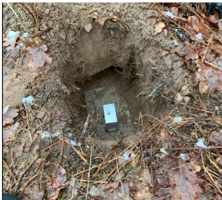
Figur 5 exempelbild Givare BV monterad på trädgårdsplatta 0,7 m i mark
