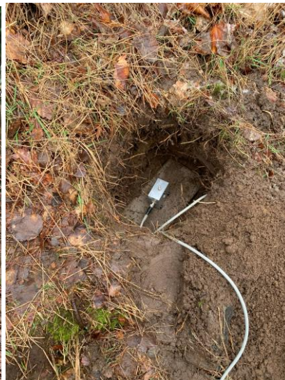
Figur 5 Montering av vertikal givare BV nära Nya Kinnavägen och foto till höger visar montage.
