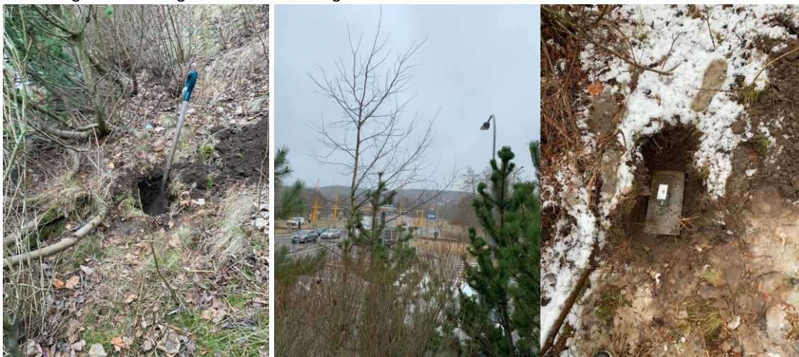
Figur 2 Montering av vertikal givare AV närmast korsningen på nya kinnavägen. Foto i mitten är taget från mätpunkten mot järnväg och Nya Kinnavägen. Foto till höger visar givaren monterad på trädgårdsplatta.
